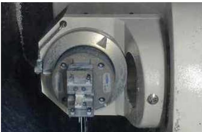
Pneumatischer Zentrischspanner PZS 2 120-60, Stufen-Wendebacken mit Gripleisten Pneumatic centre-clamping vise PZS 2 120-60, reversible stepped jaws with grip inserts
