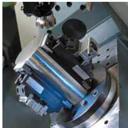
Mechanischer Zentrischspanner MZE 170-60 auf Spannturm 120° Mechanical centre-clamping vise MZE 170-60 on a clamping tower 120°
