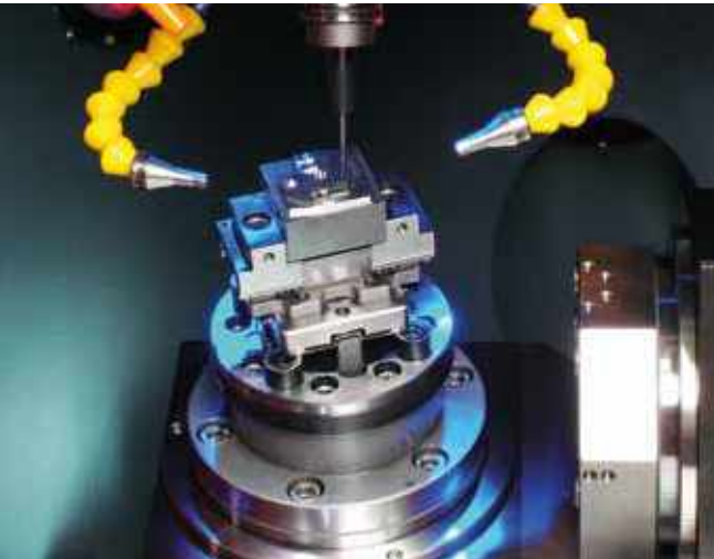
Mechanischer Zentrischspanner MZS 70-36 B auf Palette Mechanical centre-clamping vise MZS 70-36 B on pallet
