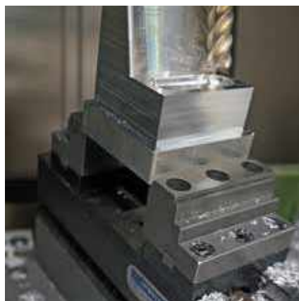
Mechanischer Zentrischspanner MZU 220-80 mit Stufen-Wendebacken Mechanical centre-clamping vise MZU 220-80 with reversible stepped jaws
