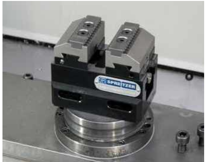
Mechanischer Zentrischspanner MZQ 110-60 Mechanical centre-clamping vise MZQ 110-60
