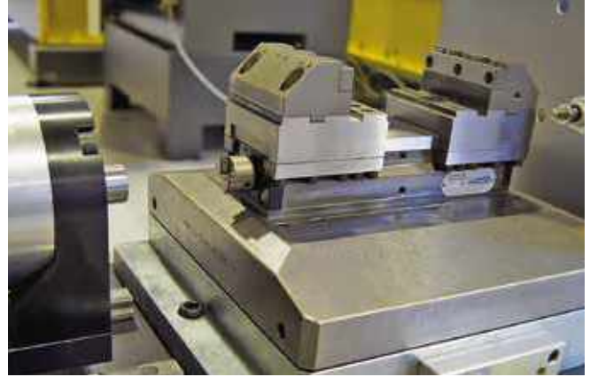
Mechanischer Zentrischspanner MZC, Antrieb über elektrischen Drehmomentschrauber Mechanical centre-clamping vise MZC, driven by electric torque wrench
