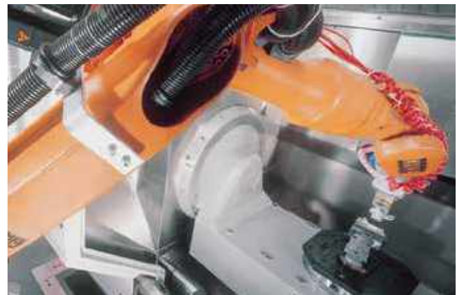
Hydraulischer Zentrischspanner HZS 120-60 in Automationszelle Hydraulic centre-clamping vise HZS 120-60 in automation cell
