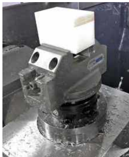
Mechanischer Zentrischspanner MZE 170-60 PA auf Palettiersystem Mechanical centre-clamping vises MZE 170-60 PA on a palletizing system
