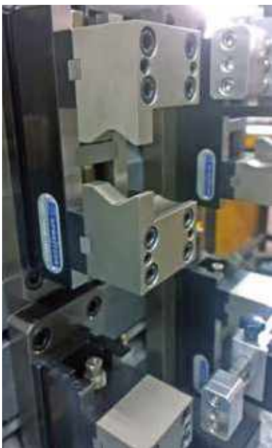
Mechanischer Zentrischspanner MZU 170-60 mit Sonderbacken Mechanical centre-clamping vise MZU 170-60 with custom designed jaws
