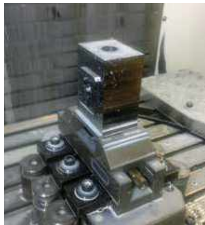
MZR 220-80 mit Kundenwerkstück (Material 1.2344) MZR 220-80 with customer's workpiece (material 1.2344)
