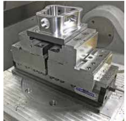
Mechanischer Zentrischspanner MZC 280-100 S auf Palettiersystem Mechanical centre-clamping vise MZC 280-100 S on a palletizing system
