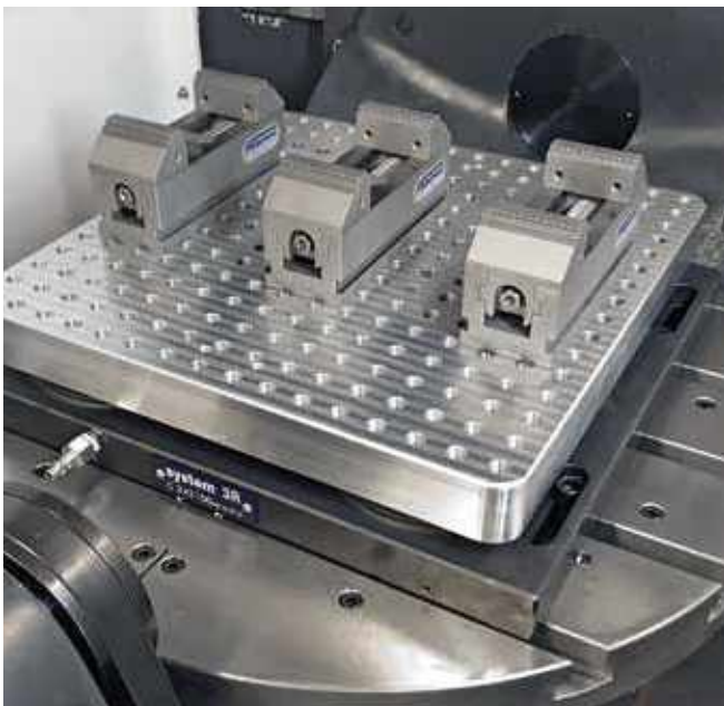
Mechanischer Zentrischspanner MZR 170-60 auf Palette Mechanical centre-clamping vise MZR 170-60 on pallet
