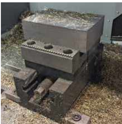
Mechanischer Zentrischspanner MZU 240-125 mit Grip-Wendebacken Mechanical centre-clamping vise MZU 240-125 with reversible grip jaws
