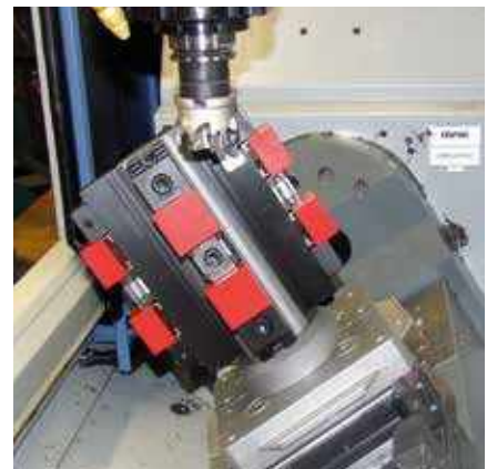
Mehrfachspannsystem MMS 260-50-1 auf Spannturm 90° Multiple clamping system MMS 260-50-1 on a clamping tower 90°
