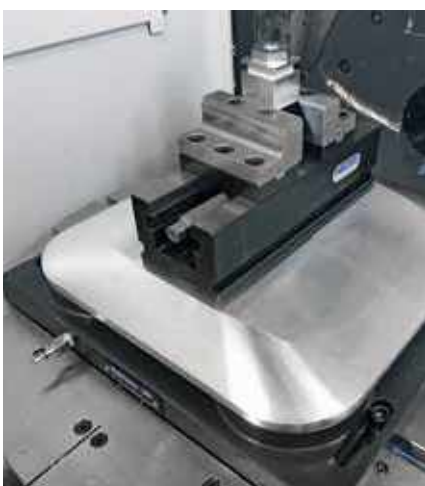
Mechanischer Zentrischspanner MZU 280-100 auf Palette Mechanical centre-clamping vise MZU 280-100 on pallet
