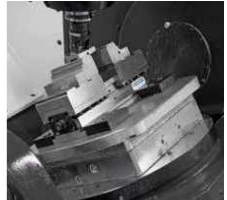
Mechanischer Zentrischspanner MZC 280-100 E auf Palettiersystem Mechanical centre-clamping vise MZC 280-100 E on a palletizing system
