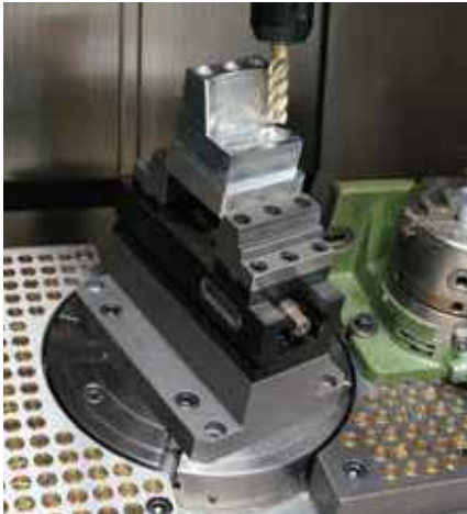
Mechanischer Zentrischspanner MZU 220-80 auf Unterbau Mechanical centre-clamping vise MZU 220-80 on base cube
