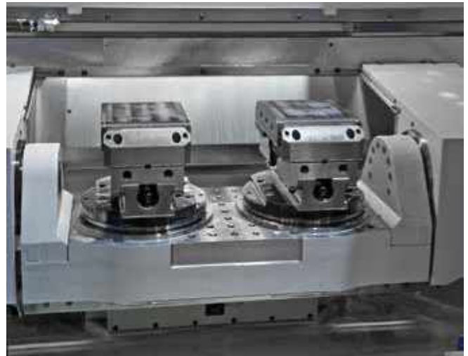
Mechanischer Zentrischspanner MZS 350-160 A auf Doppelspindel-Bearbeitungszentrum Mechanical centre-clamping vise MZS 350-160 A on double-spindle machining centre
