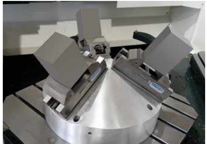
Drei mechanischer Zentrischspanner MZR auf einer Pyramide Three mechanical centre-clamping vises MZR on a pyramid
