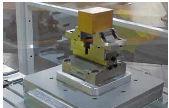
Pneumatik Zentrischspanner PZS 120-60 in Automationszelle auf Palettiersystem Pneumatic centre-clamping vise PZS 120-60 in automation cell on a palletizing system
