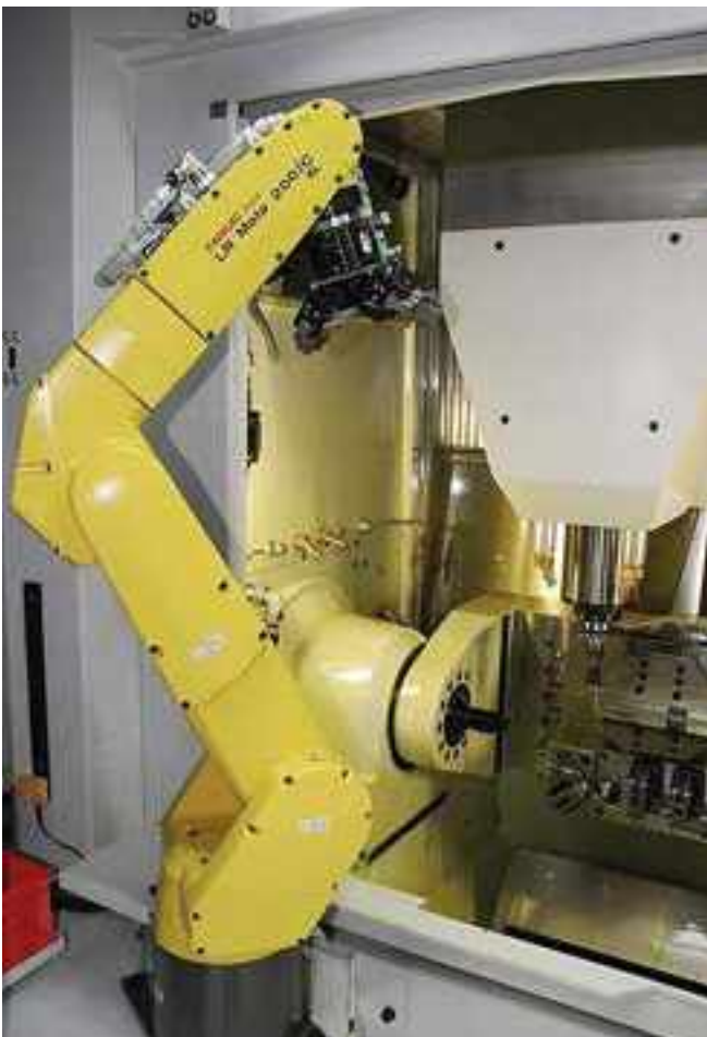
Hydraulischer Zentrischspanner HZS 180-80 in Automationszelle Hydraulic centre-clamping vise HZS 180-80 in automation cell
