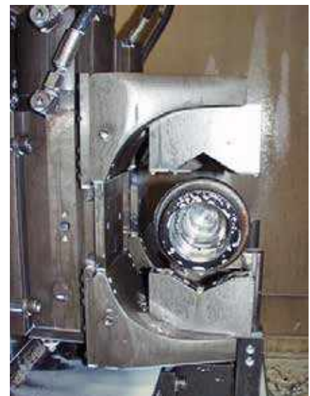
Hydraulischer Zentrischspanner HZS 250-100 D auf horizontal Bearbeitungszentrum Hydraulic centre-clamping vise HZS 250-100 D on a horizontal machining centre
