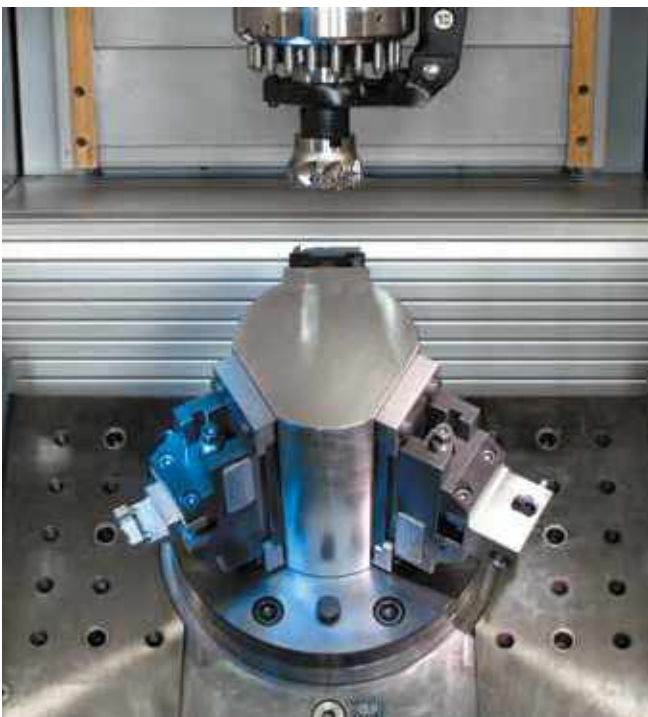
Mechanischer Zentrischspanner MZE 170-60 an 120° Spannturm Mechanical centre-clamping vise MZE 170-60 on 120° clamping tower
