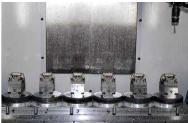
Pneumatischer Zentrischspanner PZS 120-60 A integriert in einer Spannbrücke Pneumatic centre-clamping vise PZS 120-60 A integrated in a clamping bridge
