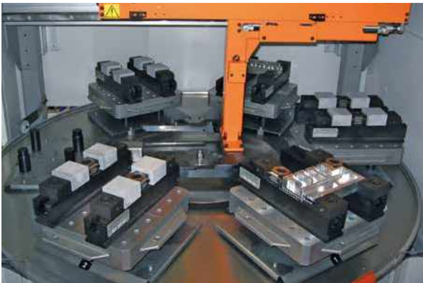
Mehrfachspannleiste MMS 260-50-1 auf Palettiersystem Multi clamping system MMS 260-50-1 on palletizing system
