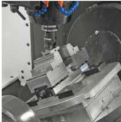
Mechanischer Zentrischspanner MZC 280-100 E Mechanical centre-clamping vise MZC 280-100 E
