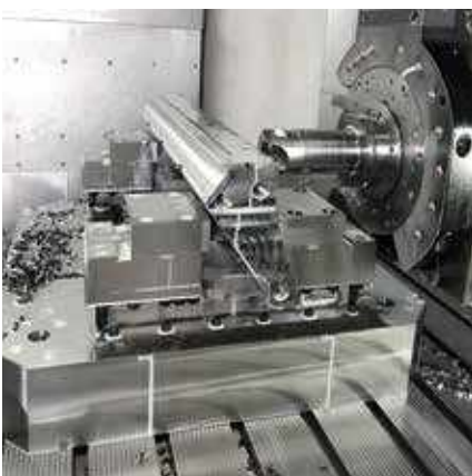
Mechanischer Zentrischspanner MZC 360-125 E mit Sonderbacken Mechanical centre-clamping vise MZC 280-100 E with custom designed jaws
