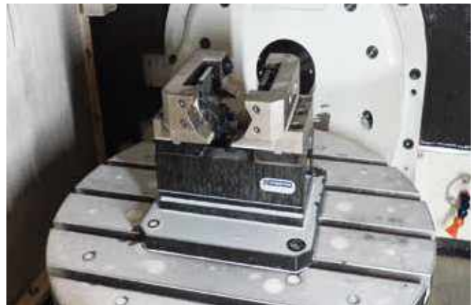
Mechanischer Zentrischspanner MZU 240-125 mit Sonderbacken Mechanical centre-clamping vise MZU 240-125 with custom designed jaws
