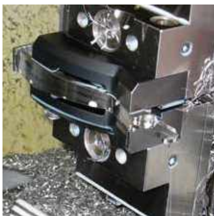
Mechanischer Zentrischspanner MZS 180-80 B mit Sonderbacken Mechanical centre-clamping vise MZS 180-80 B with custom designed jaws
