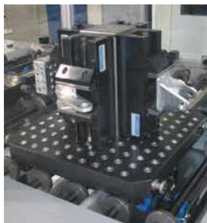
Vier mechanischer Zentrischspanner MZE 280-100 auf Spannturm 90° Four mechanical centre-clamping vises MZE 280-100 on clamping tower 90°
